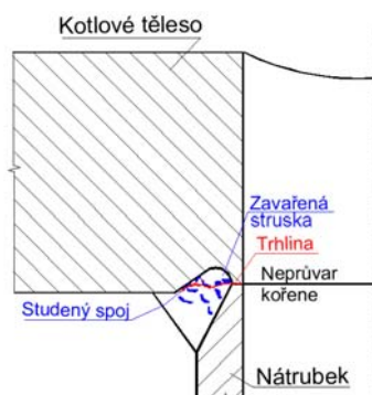
Obr.3: Vady ve svaru nátrubku
